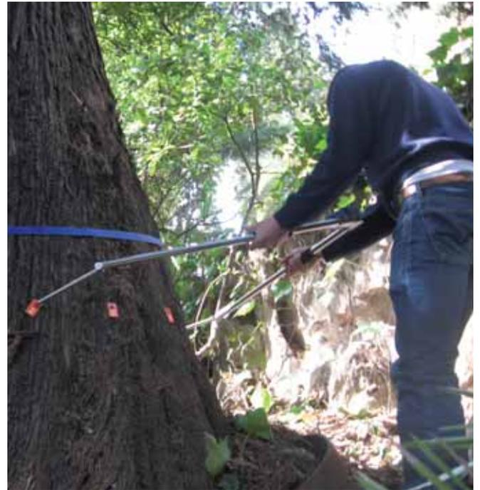
**Posizionamento strumentazione per tomografia**
