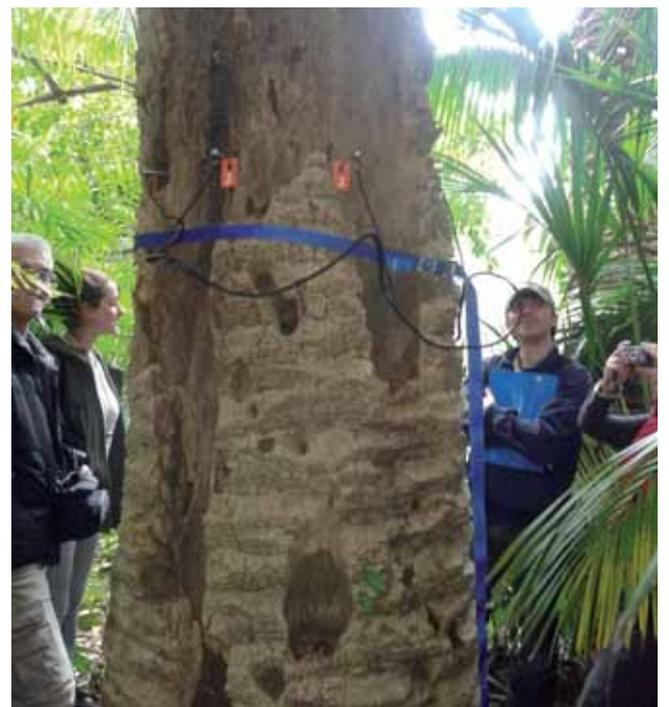
**Prova in campo sull'utilizzo del tomografo sonico**
