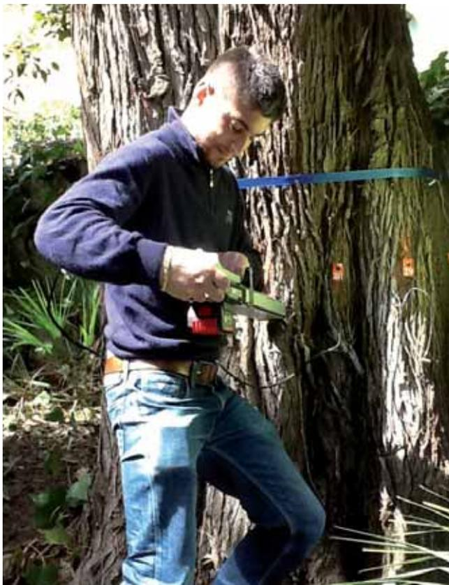
**Prova in campo sull'utilizzo del resistografo**
