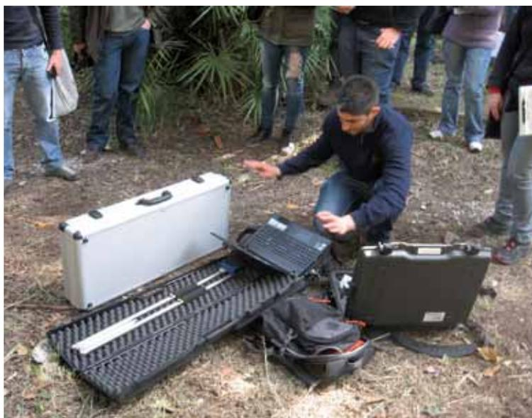
Strumentazione per restituzione dati acquisiti tramite tomografo e resistografo
